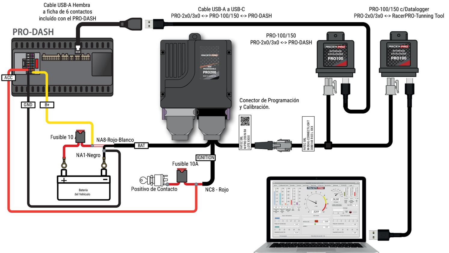
Cable USB-A a USB-C Conexión PRO-100/150 <-> RacerPRO Tuning Tool para Configuración y Datalogger
